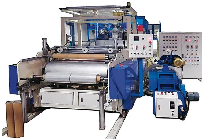
Оборудование предназначено для производства 3х и 5ти слойной стрейч пленки различного назначения. Машина оснащена автозагрузчиком материала, автоматической сменой намотки, встроенной системой рециркуляции.
