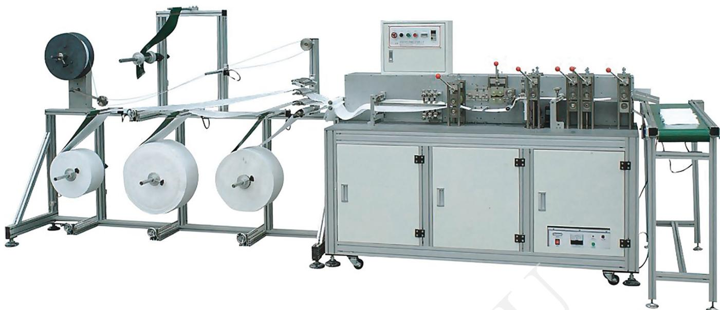
Предназначена для медицинских масок, припайка тянувшихся ушных петель к маске. Чтобы приварить эластичные ушные петли к маске, машине необходим один оператор, который будет подавать заготовки масок на подающее приспособление. Далее, машина сама будет работать и приварит петли к маске, для получения конечного продукта. Производительность – 35 шт/мин.
