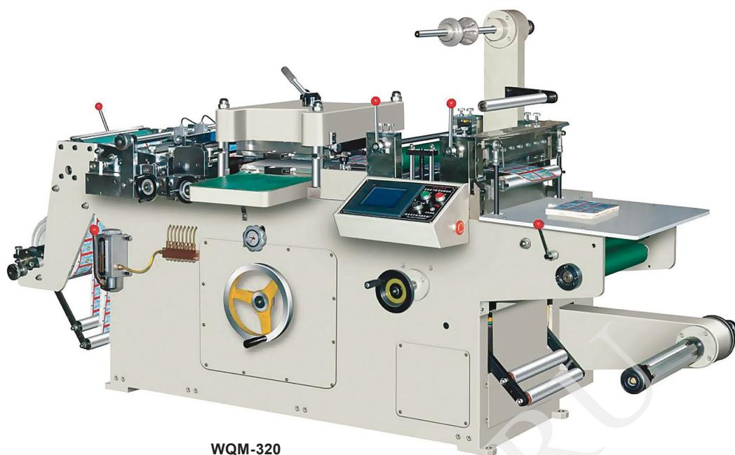
Высекально-тисильная рулонная машина серии WQM предназначена для высечки и горячего тиснения фольгой по различным рулонным материалам: самоклейка, пленка, бумага и др. WQM-машина поставляется под форматы высечки-тиснения 300\*300 мм и 400\*400 мм. Управление осуществляется со встроенной системы управления с сенсорным экраном. На машине установлена центральная система смазки всех подвижных узлов.
