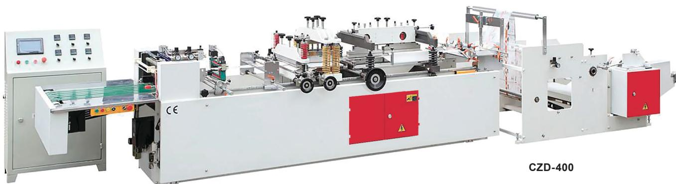
**Компактная высокоскоростная машина для производства пакетов с центральным швом и фальцем по бокам (гассетом), пригодная для мелко- и среднесерийного производства.**
