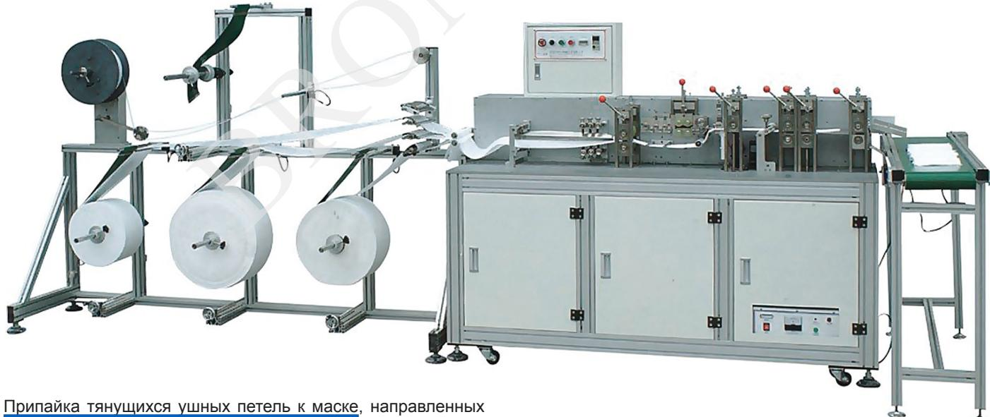
Припайка тянувшихся ушных петель к маске, направленных наружу. Чтобы приварить эластичные ушные петли к маске, машине необходим один оператор, который будет подавать заготовки масок на подающее приспособление. Далее, машина сама будет работать и приварит петли к маске, для получения конечного продукта. Производительность – 35 шт/мин.
