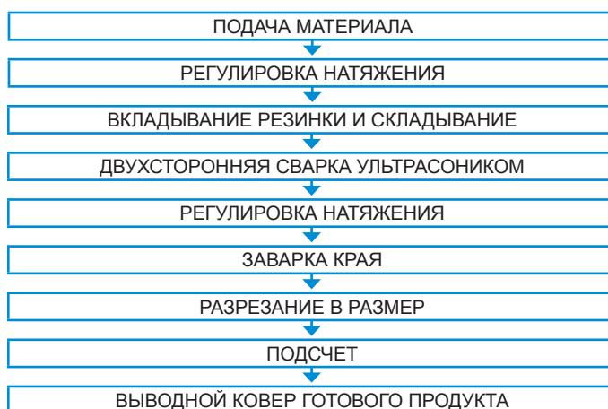
Машины для производства хирургических (медицинских) баихил. Полностью автоматические машины характеризуются высокой производительностью – 60 шт/мин. Баихлы предназначены для госпиталей, чистых комнат, пищевой промышленности и т.д. Производится три типа машин : 1) Для производства баихил из ПП пленки; 2) Для производства баихил из ПЭ пленки; 3) Универсальная машина для производства баихил из ПП и ПЭ пленок.
