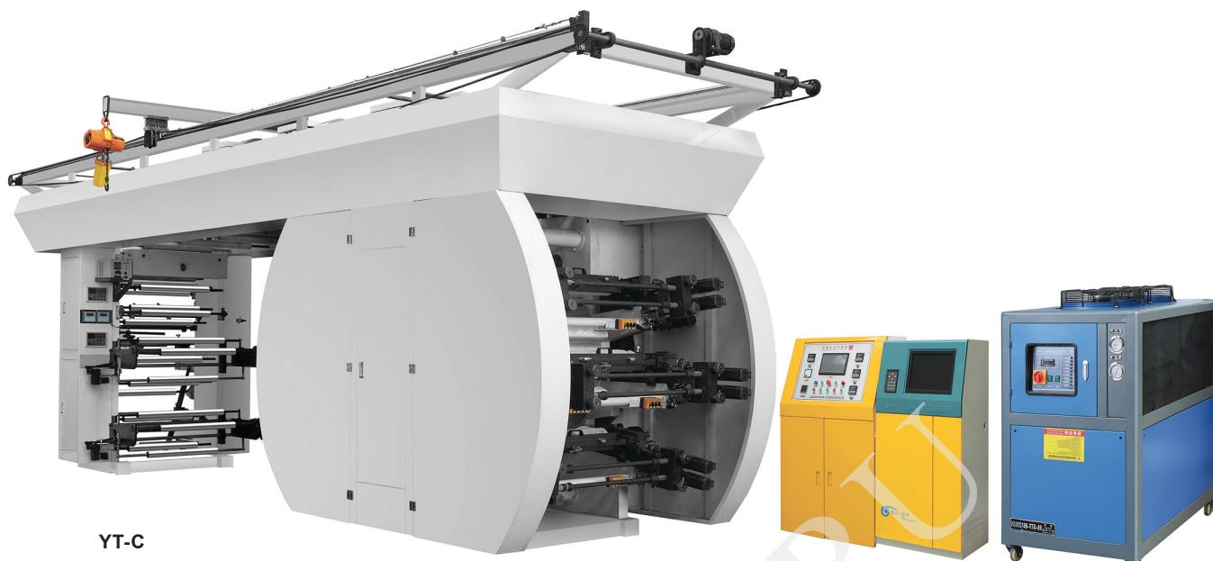
Флексопечатная машина с центральным барабаном серии YT-C подходит для печати на полиэтилене, полипропилене, шлифованной бумаге, бумаге, картоне и пр.. Это оборудование может применяться при производстве пакетов для продуктов, пакетов для покупок, пакетов из нетканого полотна, пакетов для одежды и пр.
